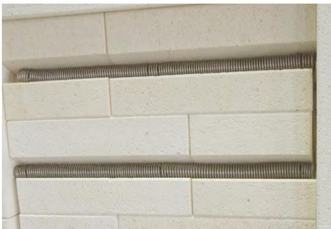
Die Beheizung kann in zwei unterschiedlichen Varianten erfolgen. Zum einen in Rillensteinen, so dass die Heizleiter gut geschützt sind oder zum anderen frei auf dem Trägerrohr, so dass eine freie Abstrahlung erfolgen kann.
